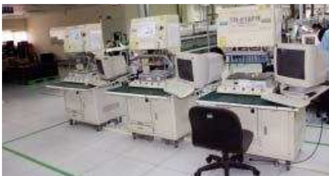
Ching Leen Electronics Co., Ltd. ist einer der EMS-Dienstleister in Taipei, der auf Test- und Inspektionsequipment von TRI setzt. Neben dem 3D AXI TR7600 SII finden sich auch Lösungen für den elektrischen Baugruppentest. Mit ca. 230 Mitarbeitern werden hier auf 6 SMD- und 3 THT-Linien Produkte für OEM's hergestellt
