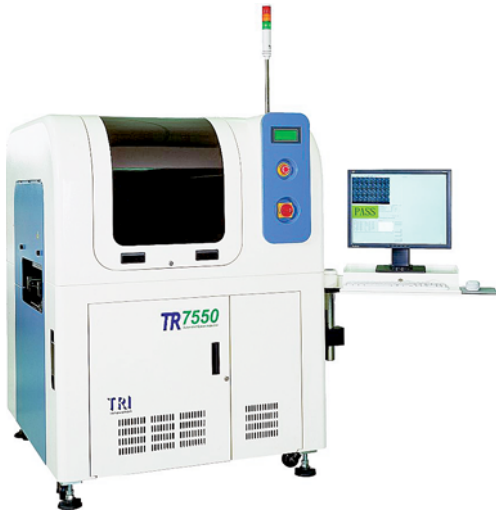
Das 3D-AOI-System TR7550 Quelle: Multi-Components
