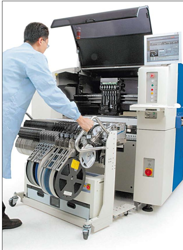
Bild 3: Feeder-Dockingwagen vereinfachen größere Umrüstungen
